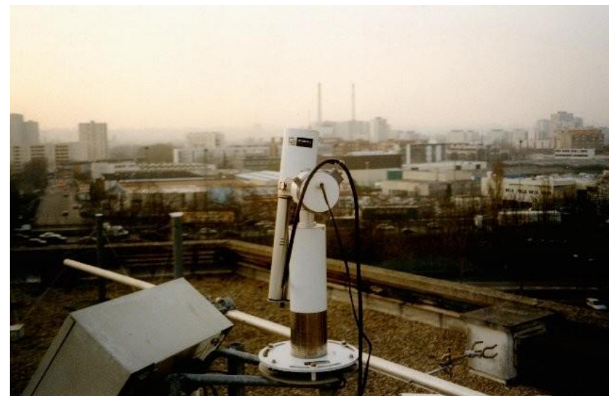
Солнечный фотометр CIMEL на станции Creteil в пригороде Парижа
